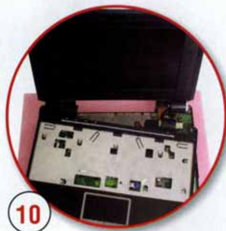
10 Отвернув два винта, снимаем крепежную скобу с жесткого диска и устанавливаем ее на новый диск
