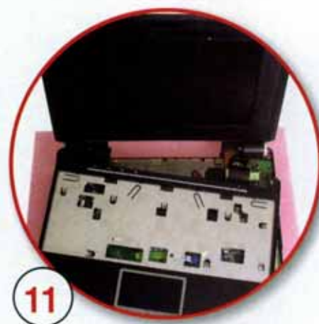
11 Устанавливаем модуль памяти и собираем нетбук в обратной последовательности
