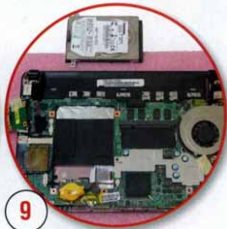
9 Собираем нетбук в обратной последовательности, не забывая подсоединить отключенные ранее разъемы
