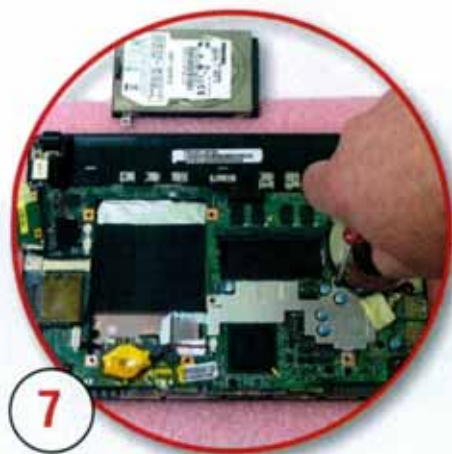
7 Отворачиваем винт, крепящий вентилятор охлаждения, и снимаем алюминиевую пластину-радиатор
