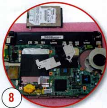
8 Наносим тонкий слой термоинтерфейса на поверхности кристаллов процессора и южного моста
